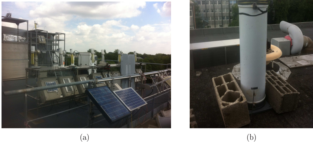
FIGURE 2.2 – Plateforme d'observation de Lille (a) vue d'ensemble et (b) micro lidar CIMEL (CAML-CE370).
