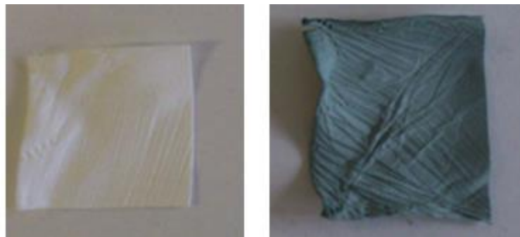
Figure 70 : Apparition de la coloration bleue sur les nanofibres de CHT-PEO réticulées à la génipine (0.1%) après leur exposition aux vapeurs d'eau à 37°C pendant 24h
