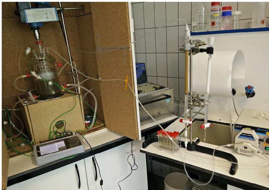
FIGURE 2.8 – Installation laboratoire du procédé d'intégration extraction-adsorption
