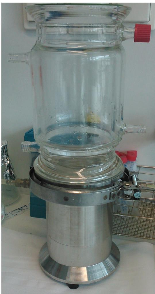
FIGURE 2.4 – Sonotrode et extracteur en verre à l'échelle laboratoire utilisés lors de l'UAE
