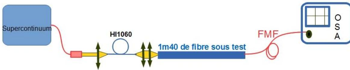
Figure 102 : Dispositif de test utilisé pour vérifier la transmission des fibres. Une adaptation de mode est effectuée en entrée des fibres sous test à l'aide d'un jeu de lentilles.
