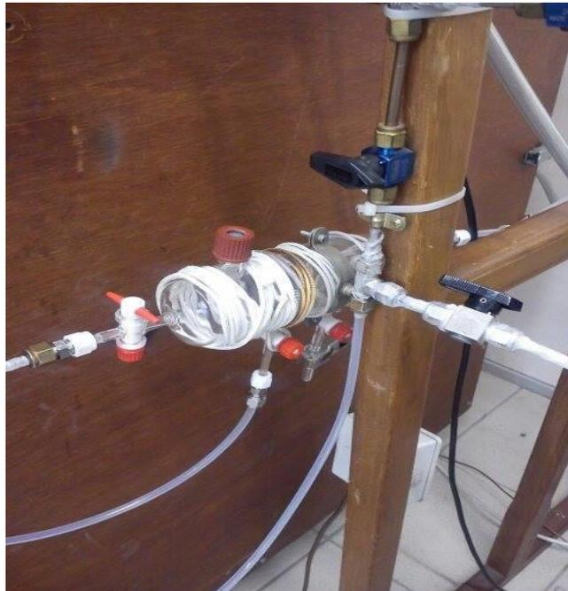
*Figure II - 4 : photographie de la chambre en pyrex pour l'introduction des réactifs dans le réacteur*
