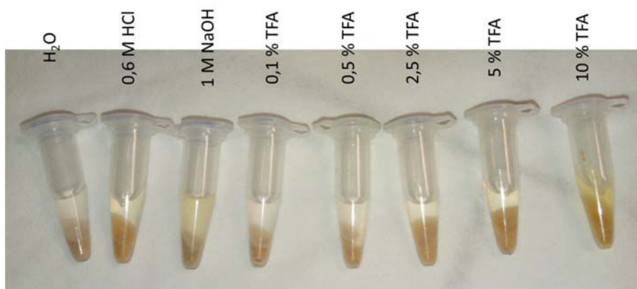
Figure 9 : Photographies de tubes contenant la poudre d'ossement avec différentes solutions de déminéralisation.
