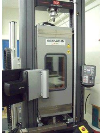
Figure II.19 : Photographie de la machine de traction avec l'enceinte climatique
