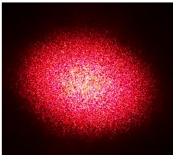
FIGURE 1.2 – Photographie d'un faisceau laser He-Ne diffusé par un mur.
