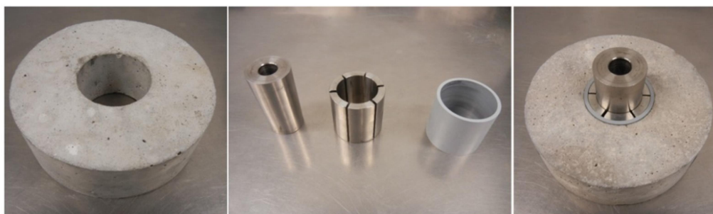
Figure 67 : Système de fissuration des éprouvettes : à gauche, éprouvette seule ; au milieu, les pièces du cœur expansif ; à droite, le cœur expansif assemblé dans l’éprouvette [23].
