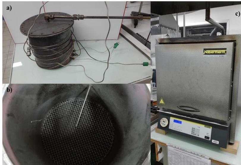
**Figure 2.2 : Pyrolyseur utilisé par le CIRAD pour la production des biochars de miscanthus**
