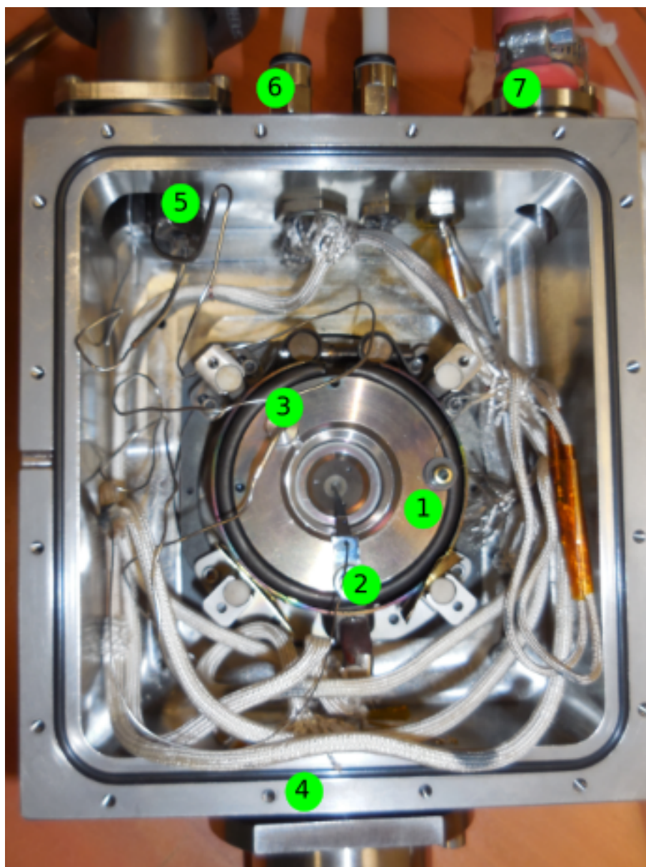
FIGURE 2.7 – Détail du dispositif de chauffage avec manchon chauffant utilisé à L'ESRF sur la ligne de faisceau ID27 pour les expériences avec \text{NaCoF}_3 . (1) cellule diamants, (2) et (3) thermocouples, (4) boîte à vide, (5) capillaire pour membrane, (6) circuit de refroidissement à eau, (7) connecteur pompe à vide
