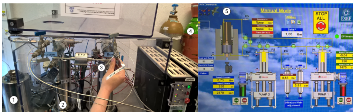
FIGURE 2.4 – Dispositif utilisé à l’ESRF pour le chargement gaz provenant de Sanchez Technologies. (1) bombonne contenant la cellule diamants. (2) et (3) pompe 1 et 2 contrôlant la membrane et l’environnement de la cellule dans la bombonne (4) Bombonne contenant le gaz que l’on souhaite charger (5) interface visuelle de commande.
