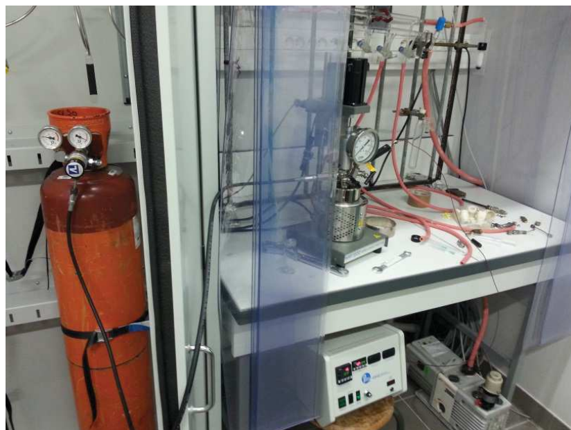
Figure 28 : Montage mis en place pour la synthèse de l'IDVE par voie acétylène
