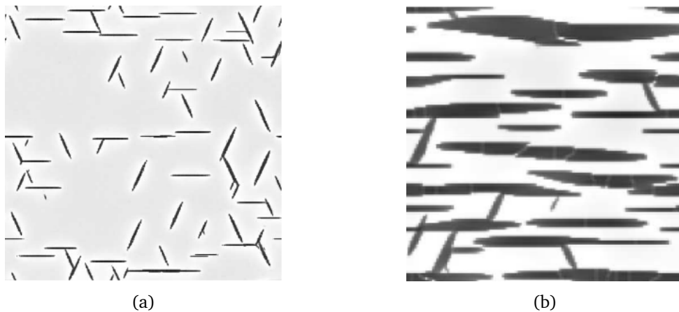
FIGURE 1.15 – (a) Simulation de la précipitation d'hydrures \gamma dans une matrice \alpha -Zr sans contrainte extérieure appliquée [157]. Les hydrures sont aléatoirement orientés le long des directions \langle 11\bar{2}0 \rangle_\alpha . (b) L'application d'une contrainte de traction verticale induit une croissance préférentielle des hydrures \gamma dans la direction dense horizontale. Les résultats sont présentés pour un maillage 2D et régulier du domaine CP adopté par les auteurs (a) 512 \times 512 et (b) 128 \times 128 .
