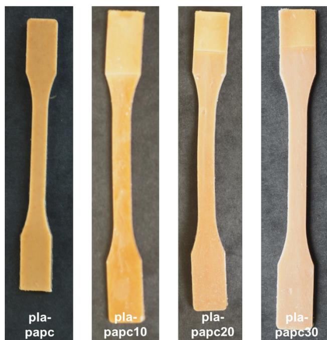
*Figure 3.43: Evolution visuelle des éprouvettes pla\_papc en présence d'humidité au cours du temps*
