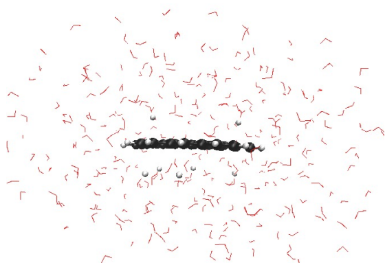
(b) Configuration 2 de l'ovalène pour laquelle l'énergie d'interaction est de -295 kJ/mol. Le PIV est de 6.45 eV.
