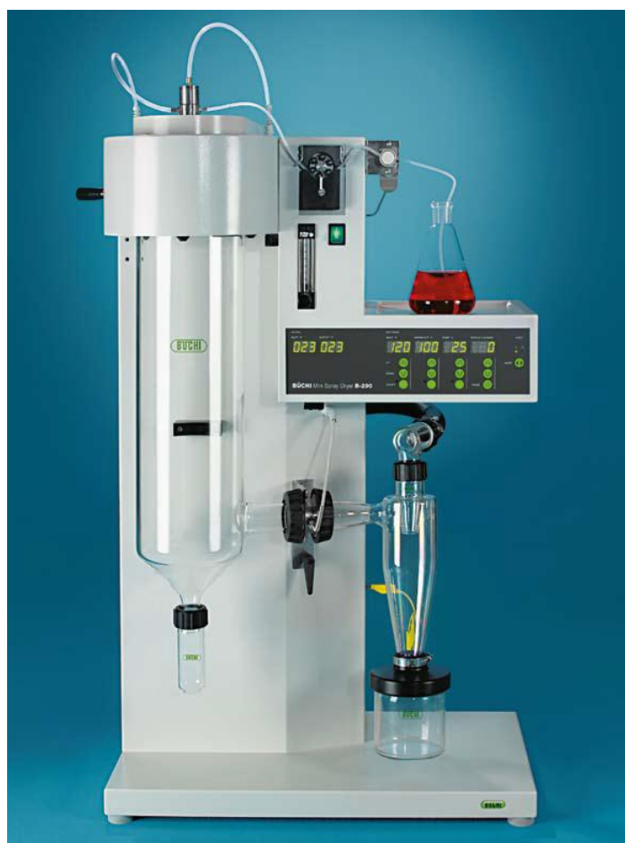
Figure 2.4 – B-290 mini spray-dryer of Buchi.
