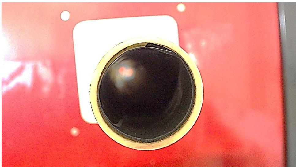
Figure 38. Chemisage du tube alumine avec la feuille d'acier 316L pré-oxydée
