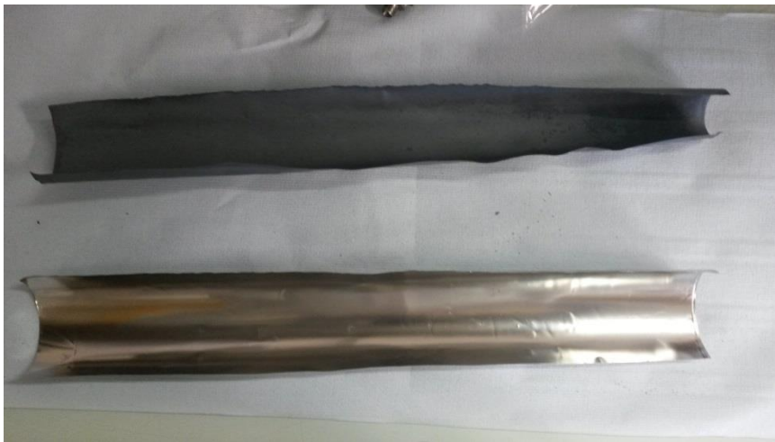
Figure 107. Feuille 316L avant pré-oxydation (en bas) et après pré-oxydation sous argon/vapeur d'eau et brossage (en haut)
