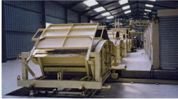
Figure 129 : Tunnel d'étuvage pour moules de voussoirs
