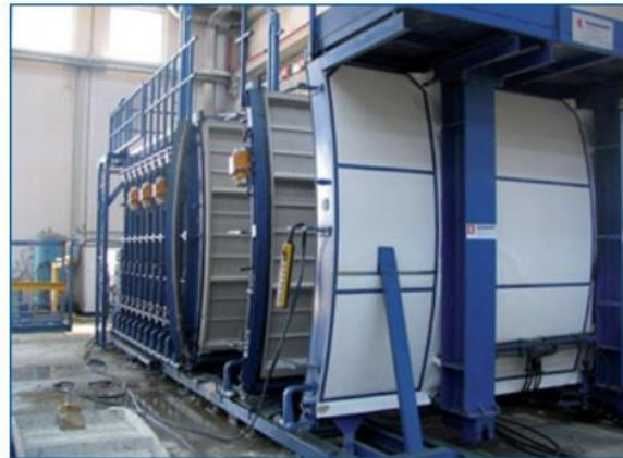
Figure 126 : Moules en batterie avec circulation de vapeur dans les caissons
