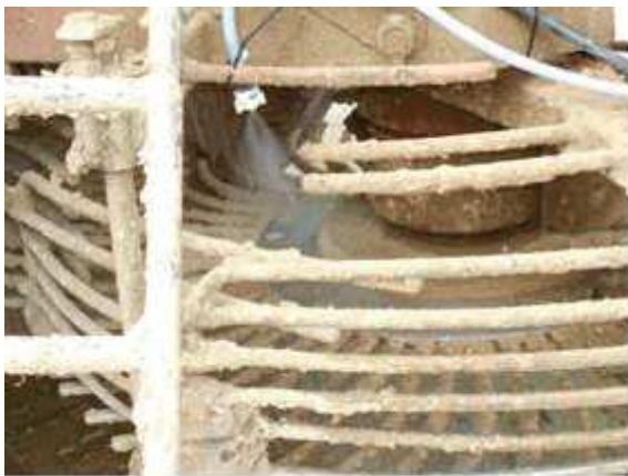
a) Turbines de nettoyage de l'arracheuse équipées d'un pulvérisateur à chaux
