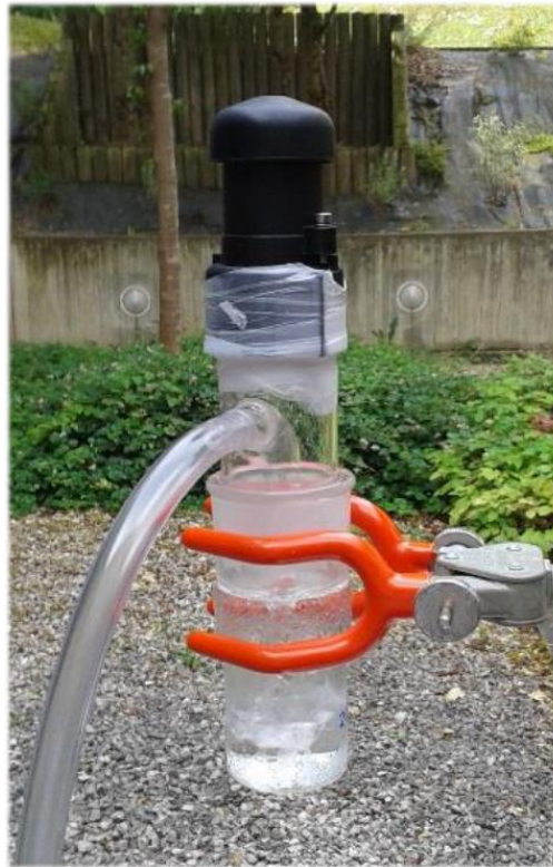
Figure 15 - Image de l'échantillonneur SKC BioSampler équipé d'un filtre particulaire (Source CSTB).
