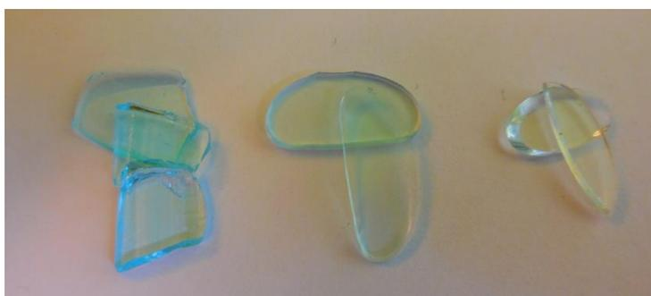
**Figure 3.30** : Photos des différents échantillons élaborés avec différentes concentrations en cuivre.
