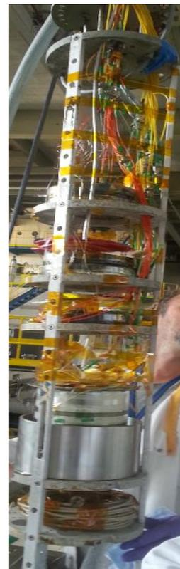
**Figure 1.15** : Système BRIGITTE utilisé pour irradier les échantillons avec différentes doses, sous rayonnements  $\gamma$ .
