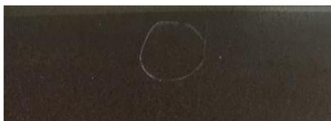
**Figure 83** : Aspect du revêtement après dépôt d'une goutte de solvant
