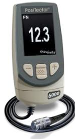
**Figure 33** : Jauge de mesure de l'épaisseur des revêtements
