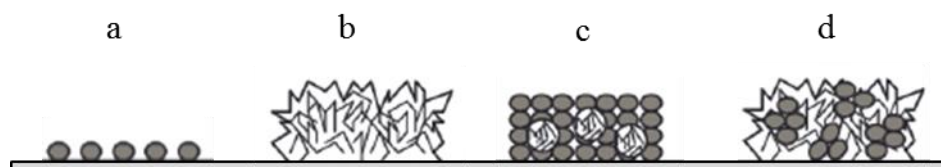
Figure 2. Exemples de dépôts formés suite à un traitement thermique des aliments : a) adsorption d'une monocouche de protéine, b) cristallisation, c) dépôt protéique avec inclusion de minéraux, d) dépôt minéral avec inclusions protéiques (Boxler, 2014).
