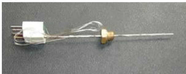
Figure 32. Sonde à fil chaud (Crattelet et al., 2013).
