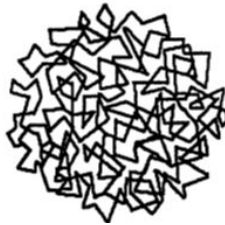
Figure 4 : Représentation schématique d'un polymère non réticulé sous forme de pelote statistique [6].
