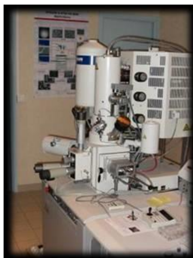
Figure 2.12. Microscopie Electronique à Balayage Hitachi S4700.
