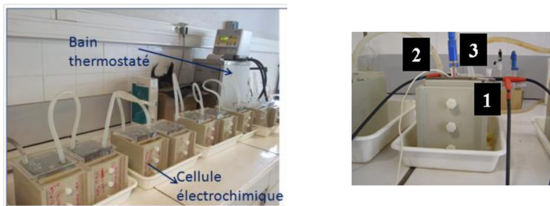
Figure 2.13. Cellules électrochimiques. 1 : électrode de travail, 2 : électrode de platine, 3 : électrode au calomel saturé.
