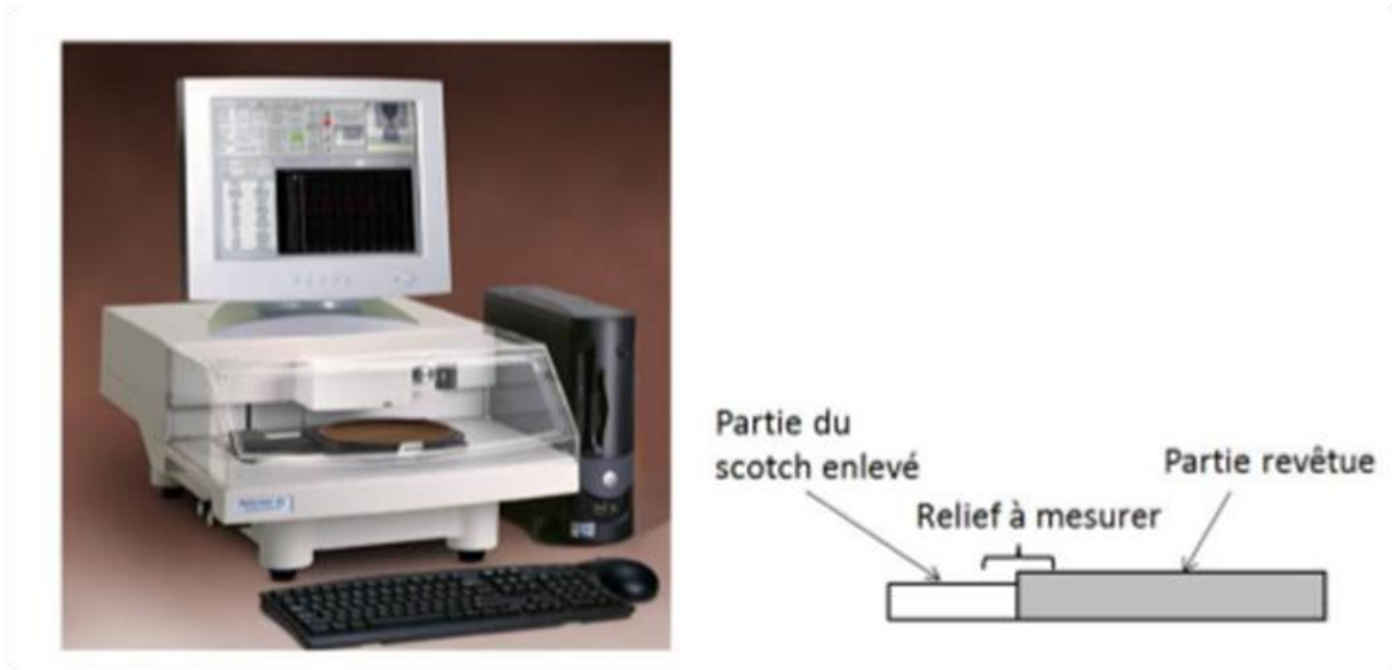
Figure 2.7. Profilomètre Alpha Step IQ et schéma du principe de la mesure de l'épaisseur d'un revêtement.
