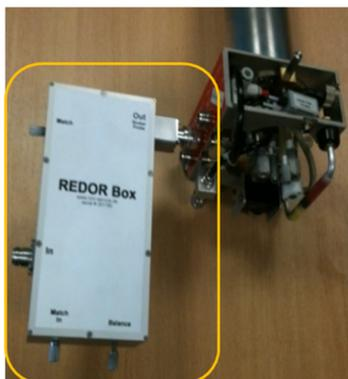
Figure I. 25- Photographie du séparateur de fréquence REDOR box fixé à une sonde RMN
