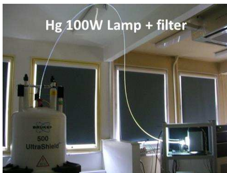
Figure A-3: Photographie du système d'irradiation in situ pour un suivi par RMN
