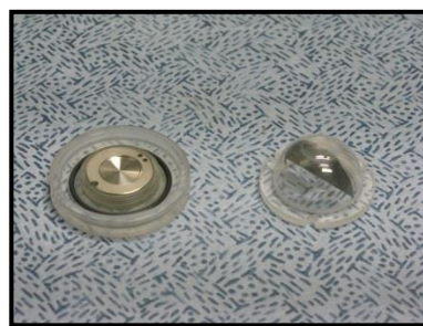
Figure A-2 : Photo du dispositif expérimental dans le cas de l'utilisation d'une assiette métallique et d'un dôme étanche.
