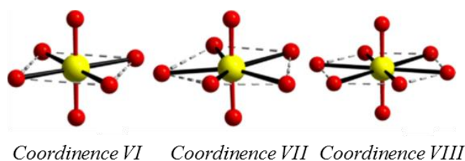
Figure 26 : Modes de coordination classiques dans les structures à base d'uranyle.
