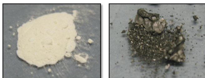
Figure 145 : Oxydes obtenus après calcination sous air à 800^\circ C d'un oxalate de thorium(IV) seul (à gauche) et d'un synprécipité uranium(VI)/thorium(IV) (à droite).
