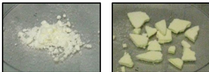
Figure 126 : Poudres précipitées obtenues à l'issue de l'essai contenant 70% de thorium(IV) (à gauche) et de l'essai contenant 30% de thorium(IV) (à droite).
