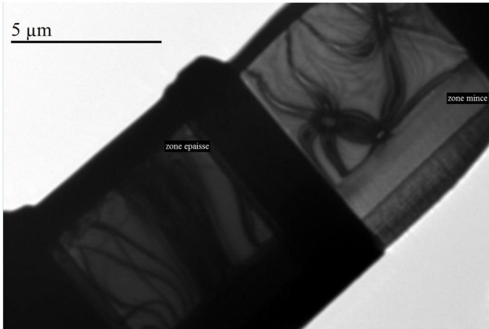
**Figure 18** : Lame FIB ayant subi un amincissement sur une partie de sa surface. On peut distinguer une zone épaisse et une zone mince.
