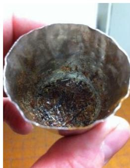
**Figure 17** : Etat du creuset après une croissance. La plupart des cristaux de spinelles sont collés sur les bords du creuset.
