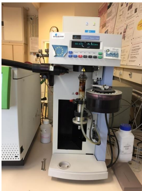
Figure 4-1: Analyse thermogravimétrique (TGA1) Perkin Elmer
