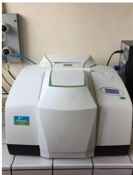
Figure 3-1: Spectromètre FTIR à transformé de Fourier pour analyse des échantillons
