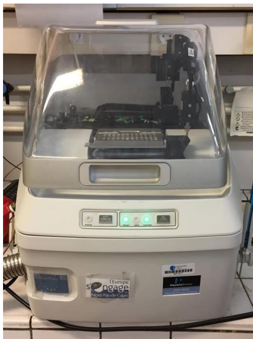
Figure 5-1: Calorimétrie différentielle à balayage (DSC 8000) Perkin Elmer
