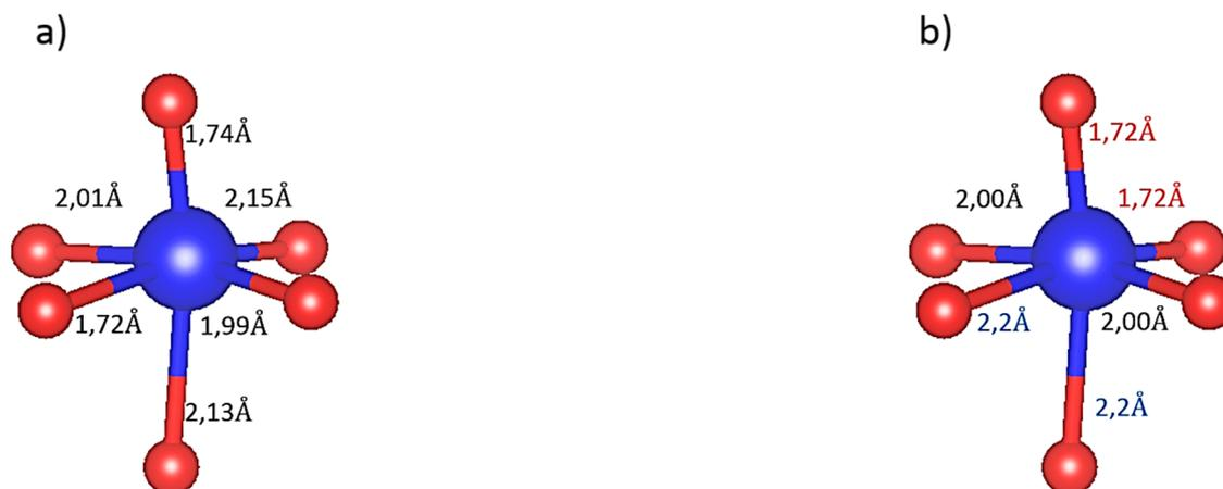
Figure 3.20: Représentation des distances Mo-O de la première sphère de coordination pour a) le site Mo1 de la phase  $\text{AgMoO}_2\text{PO}_4$  et b) la phase  $\text{RbMoO}_2\text{PO}_4$ .
