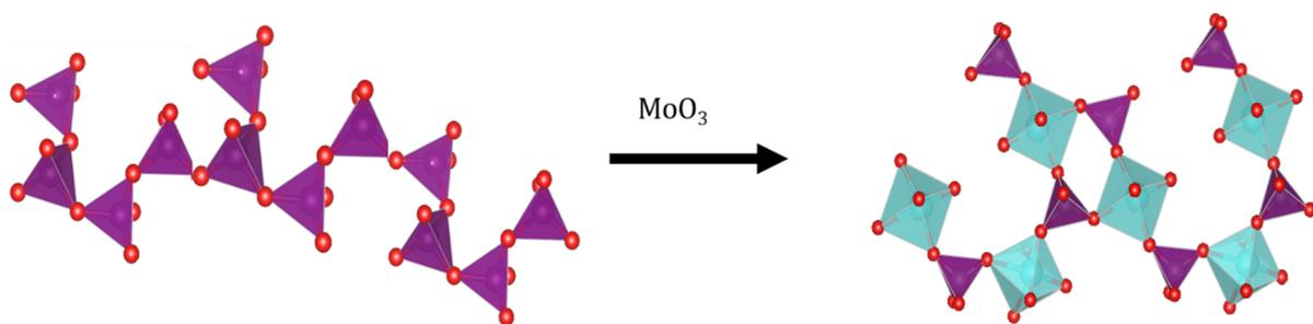
Figure 1.9: Représentation de l'insertion de  $\text{MoO}_3$  dans le réseau phosphate. Les octaèdres  $\text{MoO}_6$  sont en bleu, les tétraèdres  $\text{PoO}_4$  en violet.
