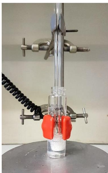
Figure 3.41 – Dispositif mis en place pour désodoriser les émoullients candidats par bullage d'argon. Un fritté de porosité 4 (taille des pores : 10-20  $\mu\text{m}$ ) est immergé dans l'émoullient à purifier et permet la formation de fines bulles d'argon au sein du liquide. L'émoullient est chauffé à 40 °C, sous agitation magnétique, et le bullage est maintenu pendant deux heures.
