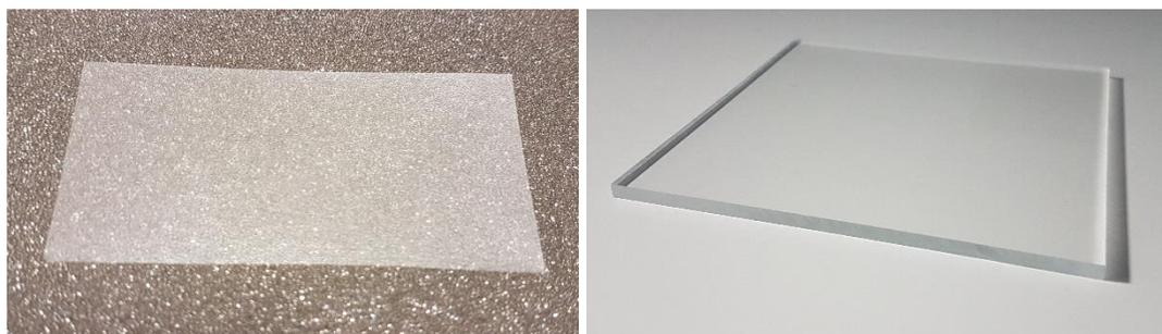
Figure 1.26 – Feuille Vitro-Skin<sup>®</sup> (gauche) et plaque de PMMA (droite) utilisées pour les mesures des angles de contact et la caractérisation des propriétés d'étalement des émoullients benchmarks et des candidats synthétisés.
