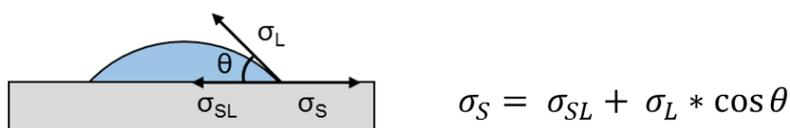
Figure 3.32 – Représentation schématisée de l'équation d'Young régissant l'équilibre des forces s'exerçant au point triple lorsqu'une goutte de liquide est déposée sur une surface solide. L'énergie de surface du solide  $\sigma_S$  étant fixe, l'étalement de la goutte sera favorisé pour une tension de surface du liquide  $\sigma_L$  et une tension interfaciale solide/liquide  $\sigma_{SL}$  faibles.
