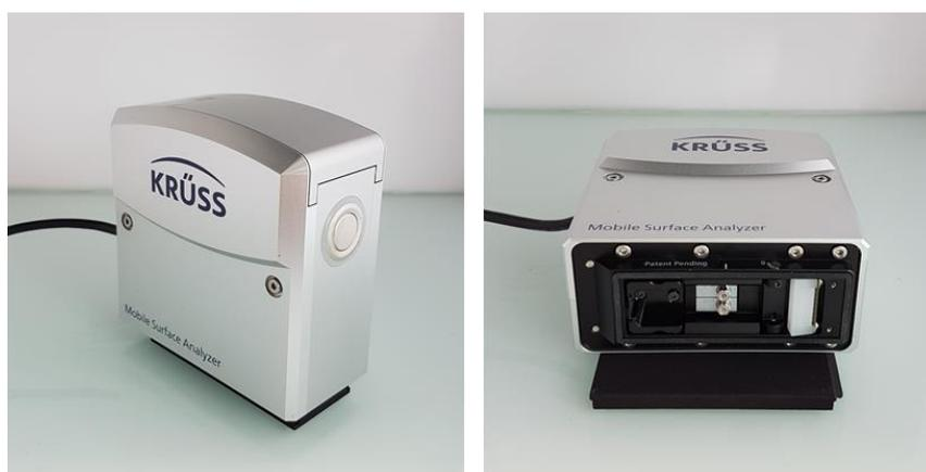
Figure 3.26 – Appareil Mobile Surface Analyzer MSA (Krüss) : vue de face (gauche) et vue du dessous (droite).
