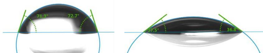
Figure 3.27 – Gouttes d'eau (gauche) et de diiodométhane (droite) déposées par le MSA (Krüss) sur une surface de PMMA et calcul des angles de contact à gauche et à droite par le logiciel *Advance*.
