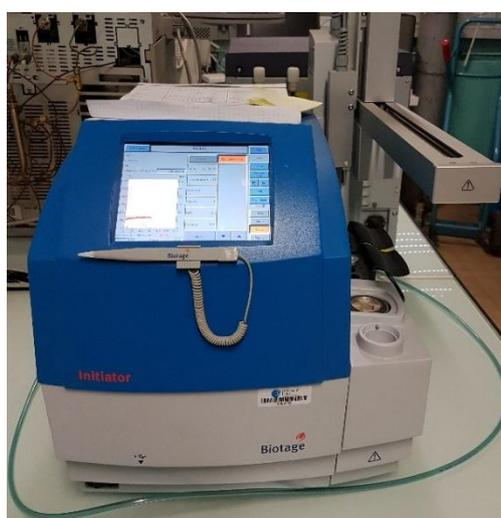
Figure 3.4 – Réacteur micro-onde utilisé pour l'addition de l'isoamylène sur le glycérol.
