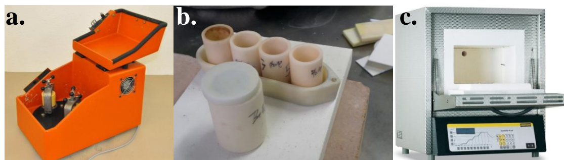
Figure 87. Matériel utilisé pour nos synthèses avec (a) broyeur planétaire (b) creusets et plaques en alumine (c) four à moufle.
