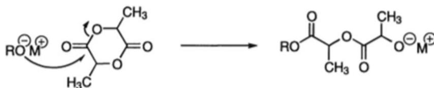
Figure 29. Mécanisme de la polymérisation anionique du lactide
