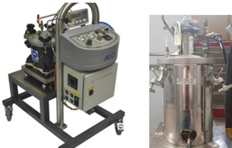
Figure 38. Photo de la cuve d'injection RTM
