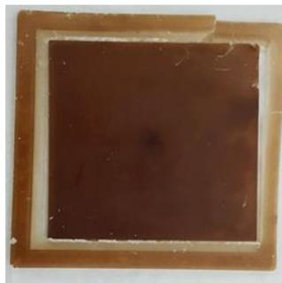
Figure 80. Plaque de polylactide synthétisée en VARTM avec  $Ti(OBu)_4$  (essai 12).
