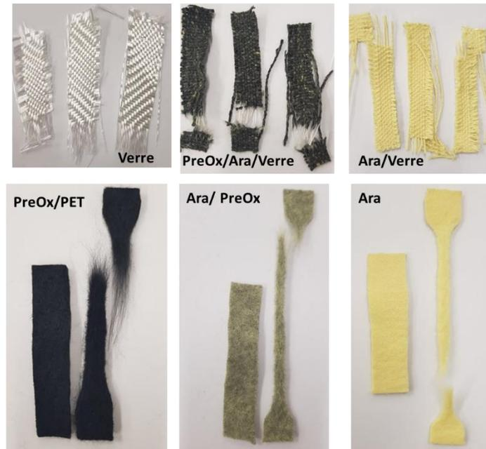
Figure 143. Photos des fibres de renfort après traction
