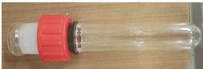
Figure 40. Tube en verre utilisé lors des essais préliminaires "en ballon"
