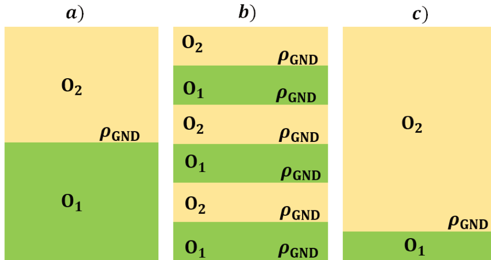
Figure 1-26 : Particularités du GOS : trois grains de tailles identiques présentant des sous structures différentes. O_1 et O_2 sont deux orientations différentes dont l'interface nécessite \rho_{GND} . Les cas a) et b) ont la même valeur du GOS mais une densité de GND différente ; alors que les cas a) et c) ont une valeur différente du GOS mais la même densité de GND.
