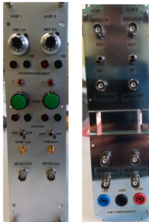
Figure 3.4.2: Photo des facades du boitiers d'asservissement. Dans la face avant on peut voir DETECTin qui correspond au signal d'entrée issue de la photodiode et VOIE1 out qui correspond à la tension de correction envoyé au mixeur (qui agit sur la puissance RF envoyé vers l'AOM).
