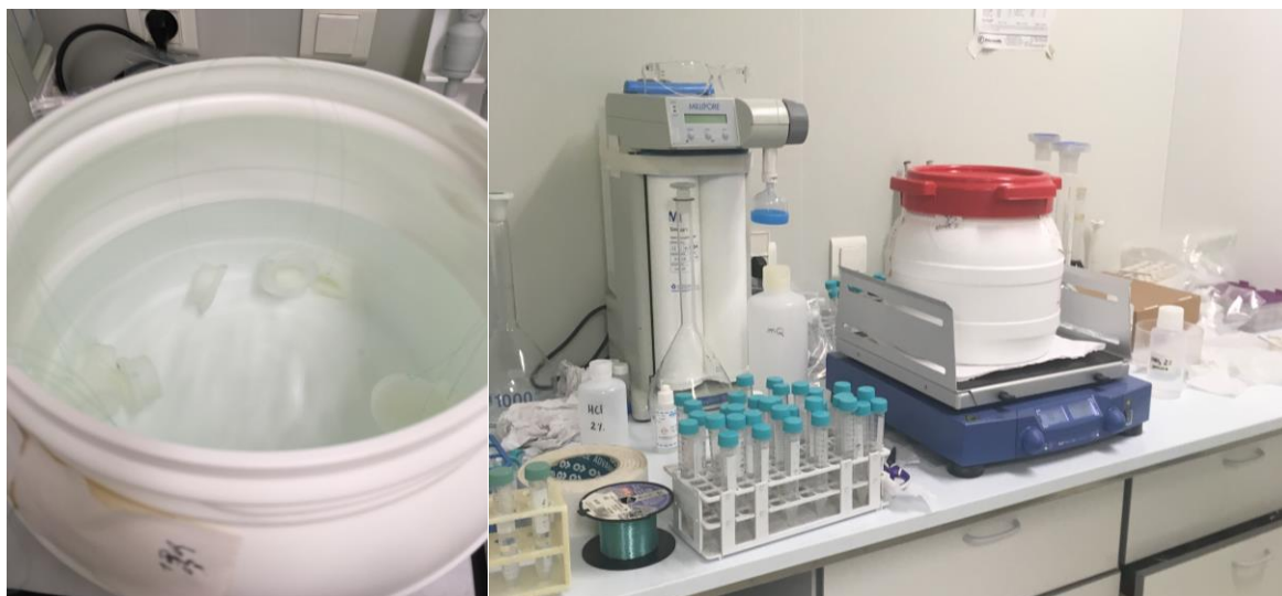
Figure 28 : Dispositif expérimental pour la détermination des coefficients de diffusion.
