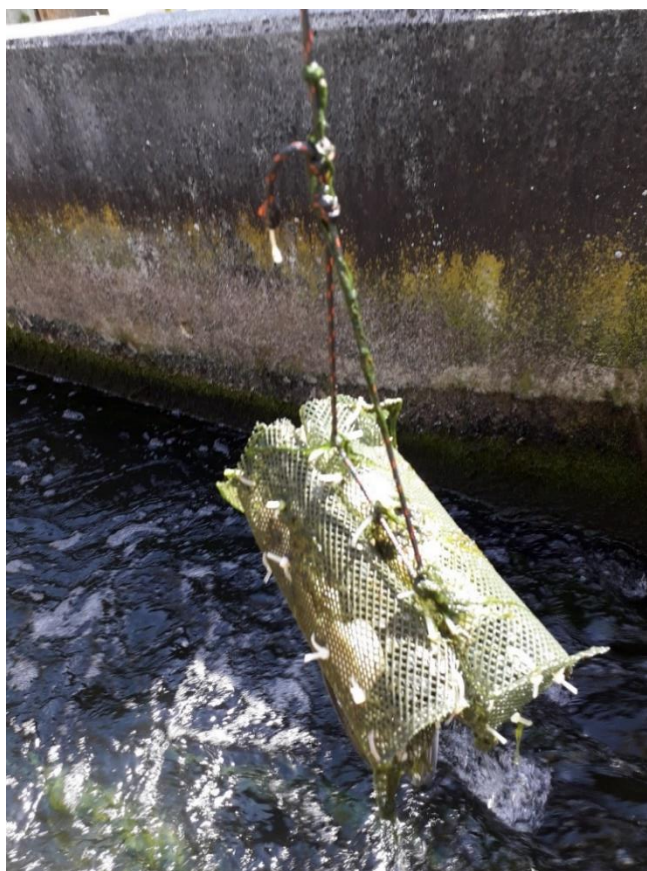
Figure 26 : Dispositif DGT utilisé sur le terrain (STEU Villeneuve-D'Ascq).
