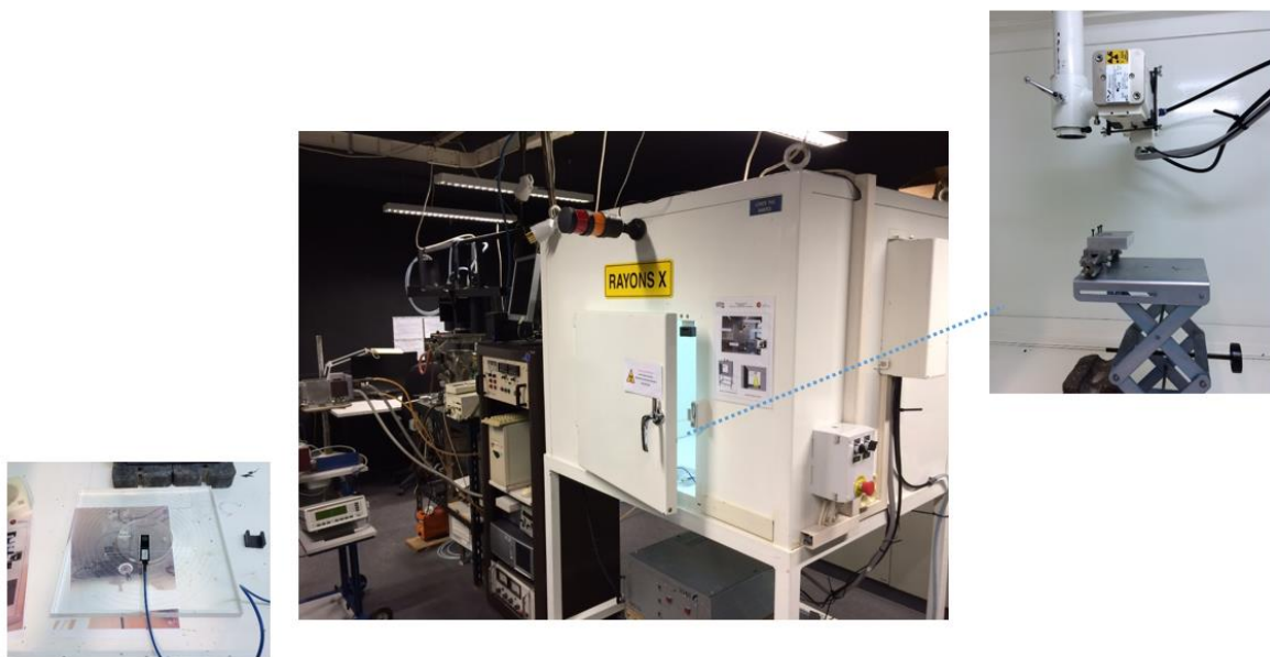
Figure 17: Photos de l'irradiateur PAX utilisé pour irradier les échantillons à l'université Nice [20].
