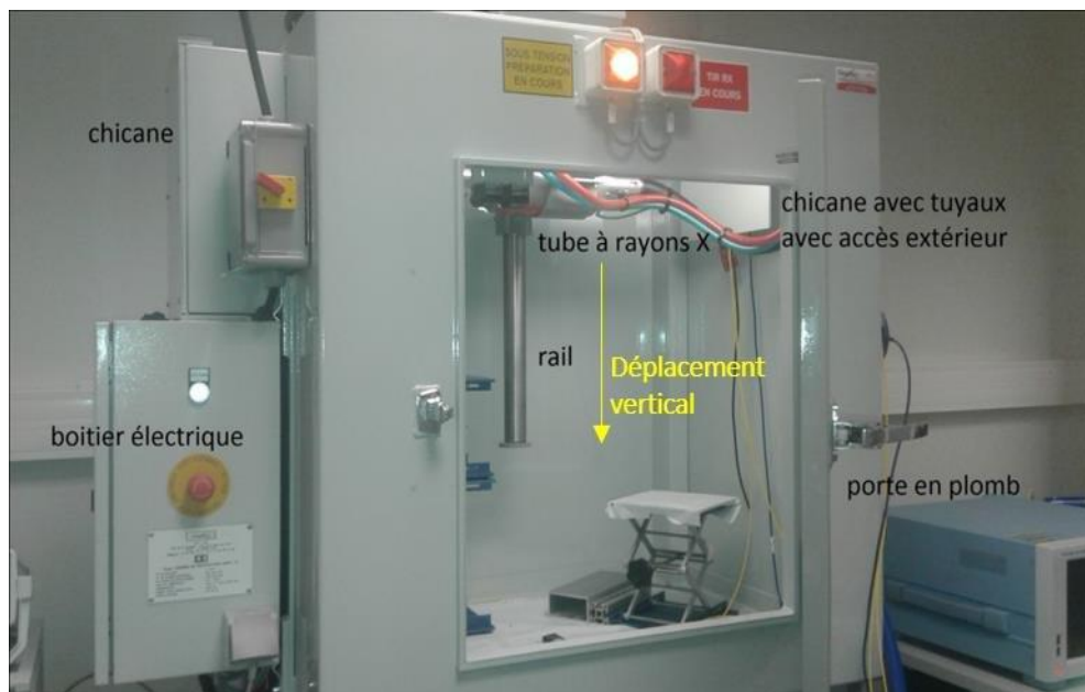
Figure 13 : Photo de l'installation MOPERIX utilisée pour irradier les échantillons [19].
