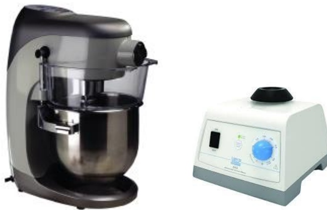
Figure 38 : Photographies des différents appareils de malaxage utilisés (Gauche : pour pâtes et mortiers à grande échelle ; Droite : Agitateur vortex pour les échantillons miniatures)
