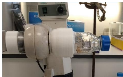
Figure 147 : Essai de granulation développé au laboratoire par analogie avec un tambour rotatif
