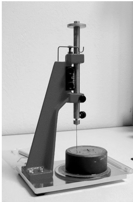
Figure 130 : Appareil Vicat pour la mesure du temps de début de prise
