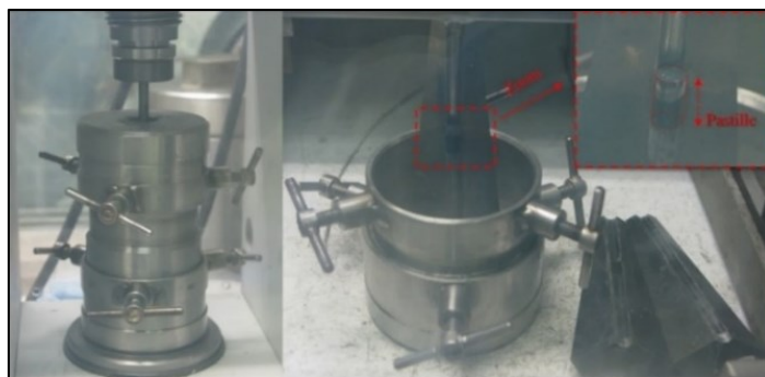
Figure n° 95 _ Dispositif de pastillage tri-coquille, procédure : 450 MPa pendant une dizaine de secondes, dispositif préalablement lubrifié avec un mélange d'acide stéarique et de solvant éther
