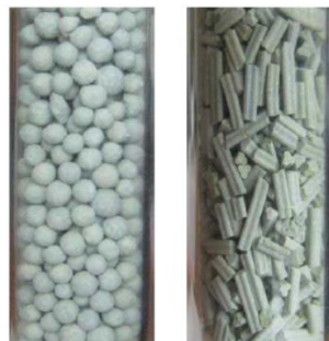
Figure 7 : Exemples d'empilements de billes et d'extrudés dans un réacteur à lit fixe
