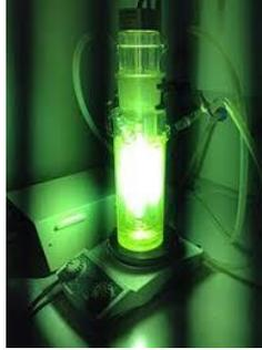
*Figure 15 : Photoreacteur à immersion*
