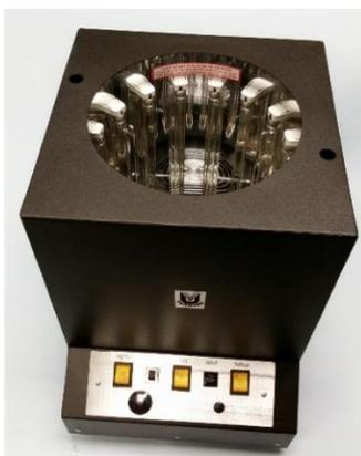
*Figure 17 : Représentation d'un réacteur de type "Rayonet"*
