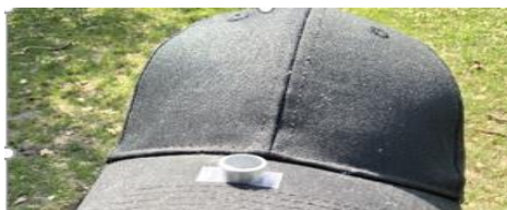
Figure 20: Pastille adhésive collée sur un plot de MEB fixé sur une casquette.
