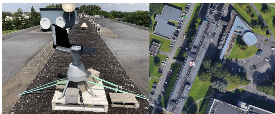
Figure 63 : Capteur volumétrique Hirst (Lanzoni, VPPS 2000) sur le toit-terrasse d'un bâtiment du campus Cité Scientifique à Villeneuve d'Ascq. Image photographique à gauche et image satellite à droite (la croix indique la localisation du capteur sur le toit). Les coordonnées GPS de la localisation du capteur sont 50°36'40.5"N 3°08'25.6"E (Google maps).
