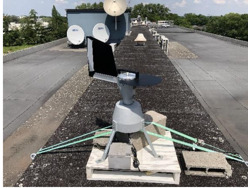
Figure 3 : Capteur volumétrique de type Hirst.
