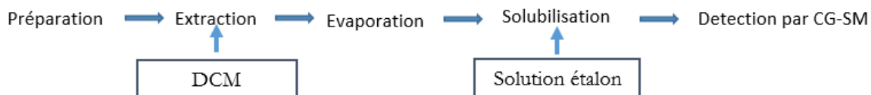
Figure 49 : Étapes de traitement d'un échantillon.
