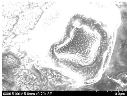
Figure 22 : Grain de pollen de bouleau observé avec un mauvais écoulement des charges électroniques.
