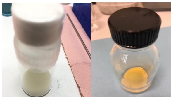
Figure 51 : Poudre de dilution à 1,5 % de pollen de bouleau intact à gauche (jaune clair) et celle à 10% de pollen à gauche (jaune foncé).
