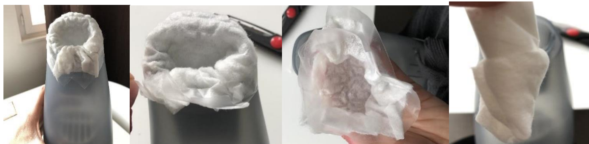
Figure 44: Fixation de la lingette électrostatique sur la buse de l'aspirateur avant d'effectuer les prélèvements (trois premières images) et lingette pliée après le prélèvement (dernière image).
