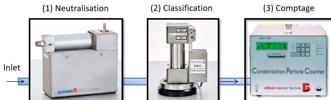
Figure II-13 Schéma du principe de fonctionnement d'un SMPS.
