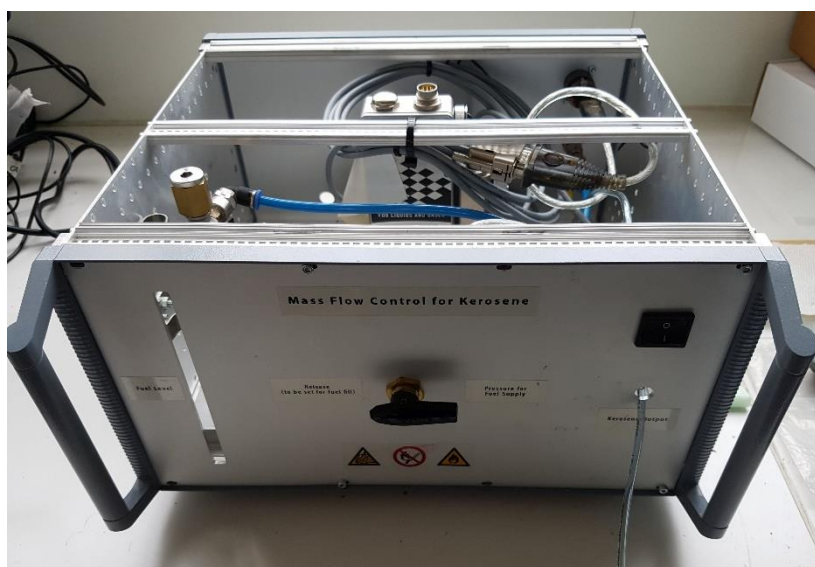
Figure III-3 Le débitmètre massique déployé pour fournir un débit en carburant continu de l'ordre de grandeur de la centaine de microlitres par minutes (Jing).
