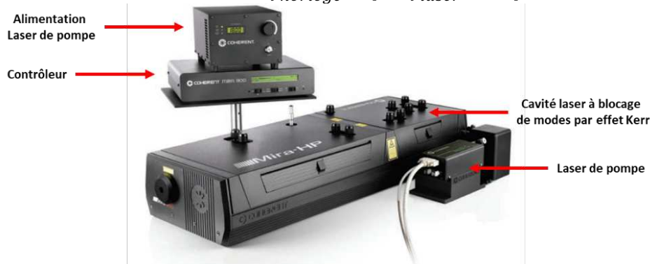
Figure 29 : Système laser Mira-Verdi proposé par la société COHERENT. L'image est directement tirée de leur catalogue produit.
