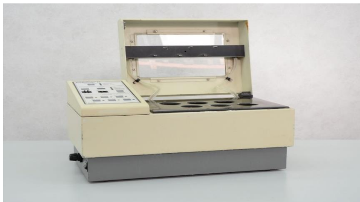
Figure 33 : Evaporateur sous flux d'azote
