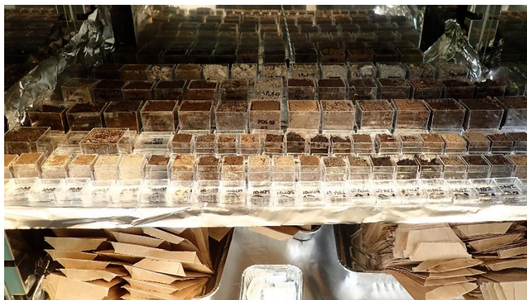
Figure 3.1 - Échantillons de sédiments de surface placés à l'étuve au laboratoire de Biomar, à Port-aux-Français
