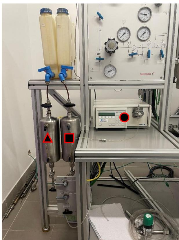
Figure 5 Photographie du circuit d'alimentation en liquide du pilote (▲ : réservoir d'alimentation en SRGO seul, ■ : réservoir d'alimentation en SRGO dopé avec un agent sulfurant, ● : pompe GILSON + tête de pompe injectant le liquide dans le pilote)
