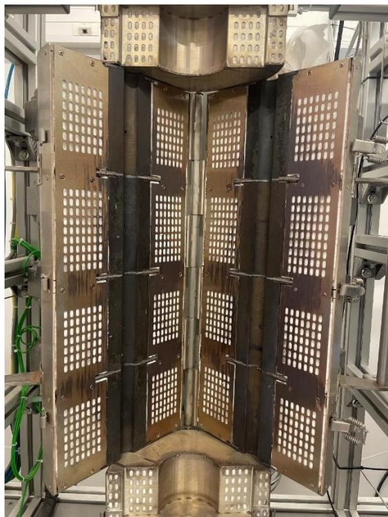
Figure 6 Photographie du système de chauffage du micro-pilote montrant les quatre coques chauffantes et la gaine contenant le réacteur et les gaines lors des activations/tests
