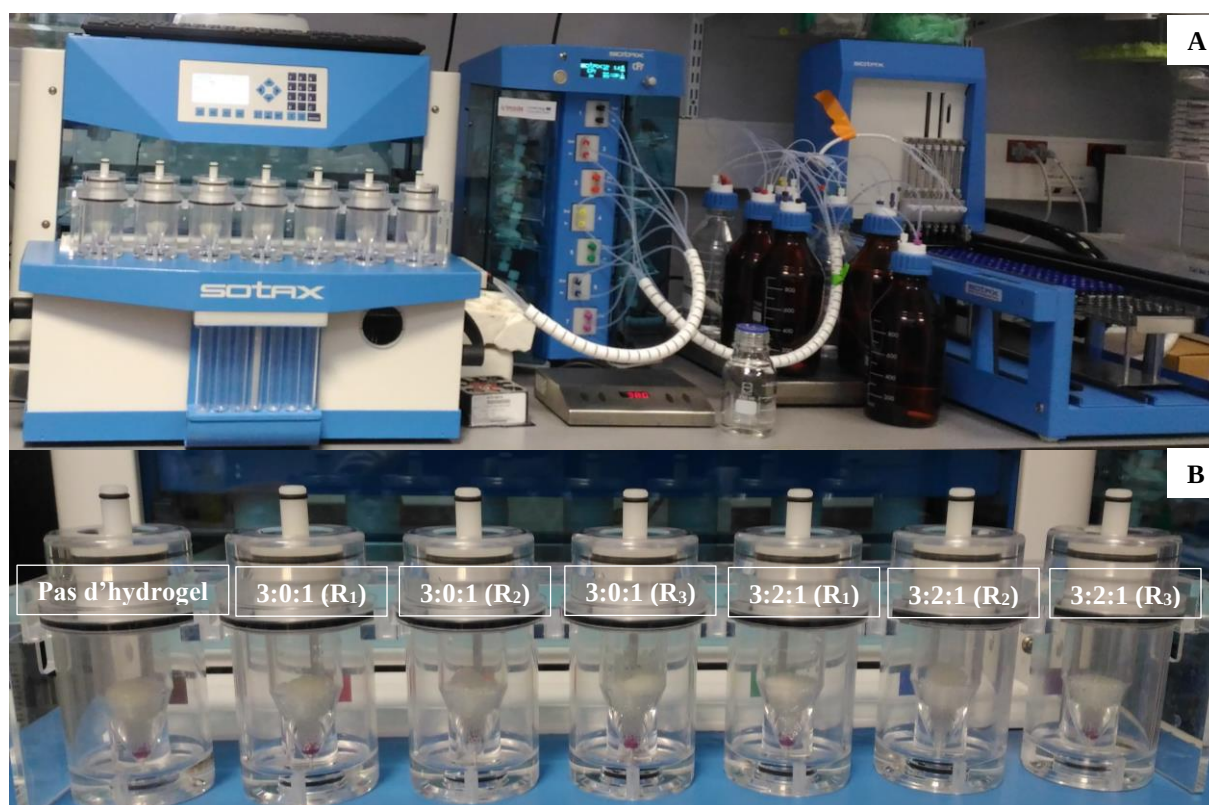
Figure 60. (A) Appareil de dissolution en flux continu SOTAX® CE7 Smart-USP IV (SOTAX®, Aesch, Suisse) disponible au laboratoire de l'équipe INSERM U1008 "Advanced Drug Delivery Systems", Université de Lille (B) Plan d'expérience de mise des hydrogels dans les cellules de libération
