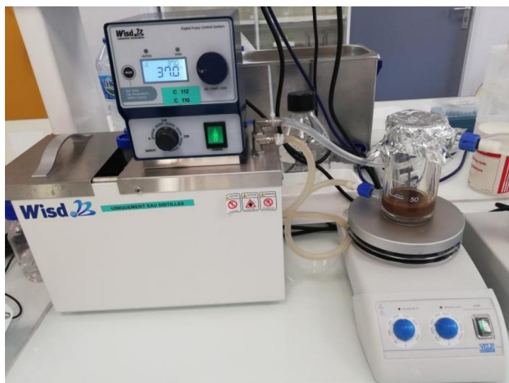
Figure 61. Montage utilisé pour la réalisation de la digestion gastro-intestinale in vitro de l'extrait brut méthanolique des rhizomes de J. inflexus localité 3 (Boutahiri, 2022)
