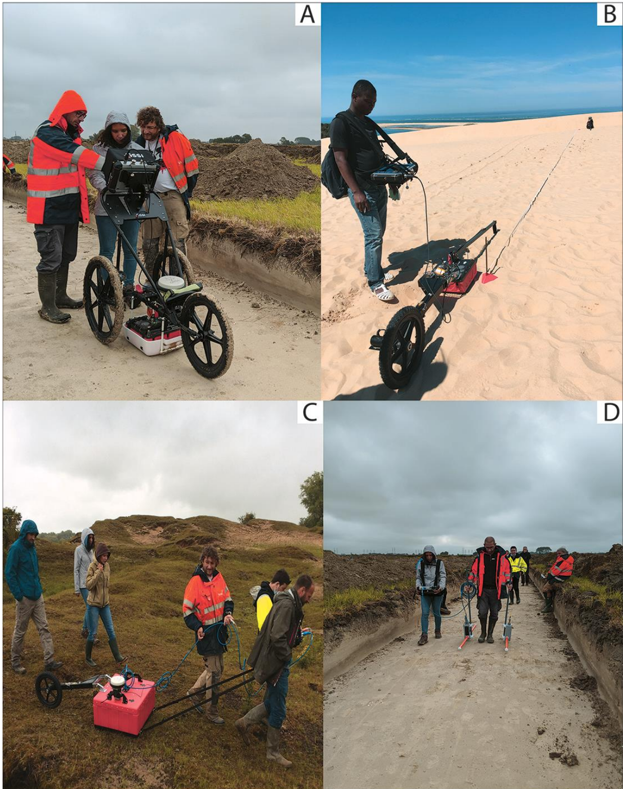
Figure III-1 : Différentes antennes géoradar: (A) 350 MHz avec chariot sur le chantier archéologique à Loon-Plage, (B) 350 MHz avec roue codeuse sur la dune du Pilat, (C) 200 MHz avec roue codeuse sur la dune de Ghyvelde, (D) MLF3200 (en configuration 80 MHz) sur le chantier archéologique à Loon-Plage.
